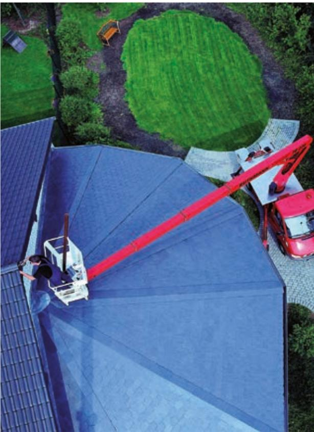
Bei der Positionierung eines Arbeitskorbs können smarte Aktuatoren die Bewegungen begrenzen und damit das Gefahrenpotenzial senken.
